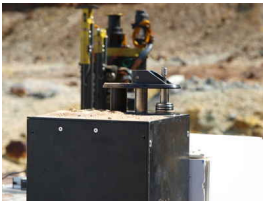
Figura 1: Detalle del conjunto instrumental para IceBreaker con SOLID en primer término. Créditos: CAB/NASA-Ames.
