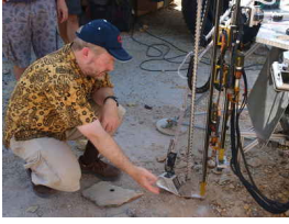
Figura 4: Brian Glass junto a la perforadora extrayendo muestras del suelo para entregarlas a SOLID para su análisis. Créditos: CAB/NASA-Ames.
