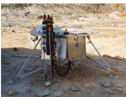
Figura 2: Perforadora y su acoplamiento con SOLID sobre una maqueta del módulo de aterrizaje de la sonda Phoenix . Créditos: CAB/NASA-Ames.
