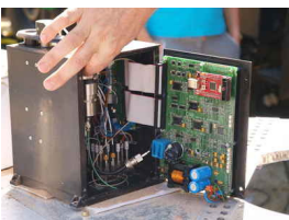
Figura 3: Detalle del interior del instrumento SOLID preparado para el análisis de las muestras. Créditos: CAB/NASA-Ames.
