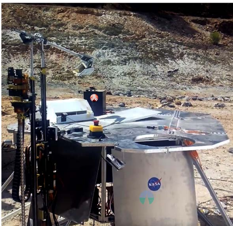
Figura . Imagen de SOLID 3.1, de color negro, sobre la plataforma de aterrizaje. A la izquierda de la imagen se aprecia claramente el sistema de perforación. © CAB
