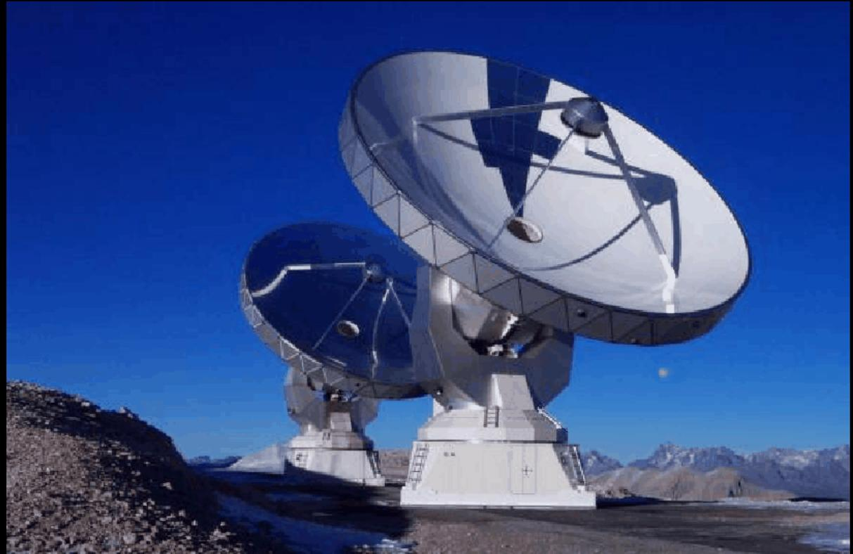
La resolución angular es  $\sim$  la de un telescopio de diámetro igual a la distancia cubierta por las antenas
