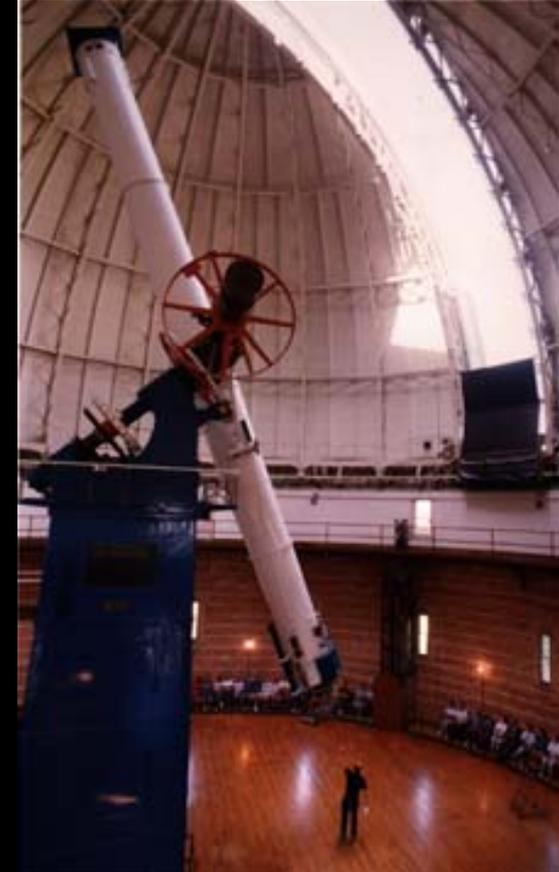
Telescopio de Yerkes de 40" ( $D = 1 \text{ m}$ ,  $f = 19.4 \text{ m}$ )
