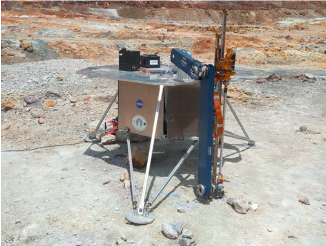
Figura 2. Plataforma sobre la que se instaló el taladro automático durante la campaña LMAP-2017 en la cuenca del Río Tinto. ©CAB
