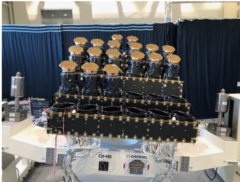
Imagen 1: Módulo de carga útil en integración en la sala blanca de OHB System AG. Crédito: OHB
