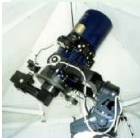
Figura 1: El telescopio de 30 cm de BOOTES-1 con las cámaras de gran campo de 16° x 11° y el espectrógrafo estelar de campo ancho montado en el foco Cassegrain con una cámara CCD adosada.
