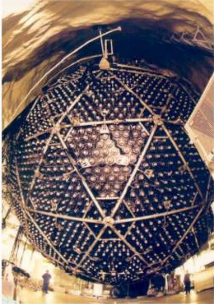
Montura esférica geodésica donde están montados los fotomultiplicadores en el Sudbury Neutrino Observatory.
