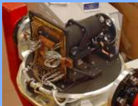
Figura 4: Dos vistas de uno de los criostatos de pruebas de EMIR, utilizado para la caracterización del detector Hawaii-2 y el sistema de adquisición de datos. El equipo de EMIR está preparando otros criostatos para probar los prototipos de los diferentes subsistemas (óptica, opto-mecánica, motores, etc.) en las condiciones de operación.
