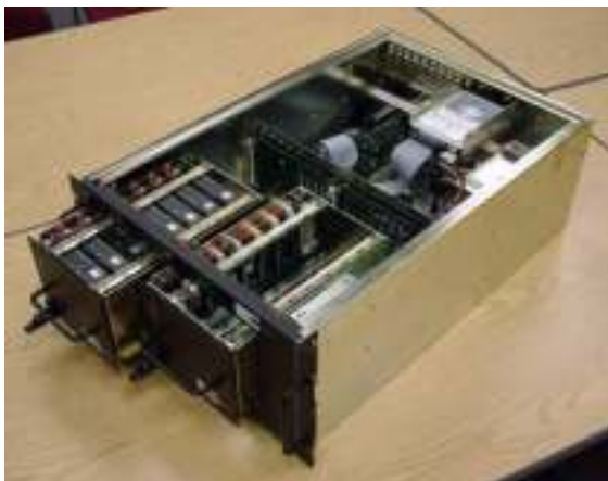
Figura 1. Nuevo sistema de grabación Mark 5 basado en arrays de discos magnéticos.
