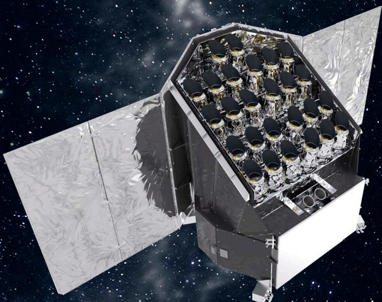
Impresión artística de la misión PLATO. La carga útil consta de 26 telescopios. Dos cámaras más pequeñas, vistas en la parte inferior derecha, no forman parte de la carga útil, sino que se trata de cámaras de seguimiento de estrellas, utilizadas para la orientación. **Créditos: ESA/ATG Medialab.**
